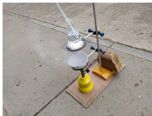
Figura 4. Si bien se usaron los mismos instrumentos, en esta foto el matraz se encuentra muy alejado. En las mediciones realizadas el matraz se encontró justo por encima de la cápsula de porcelana.
