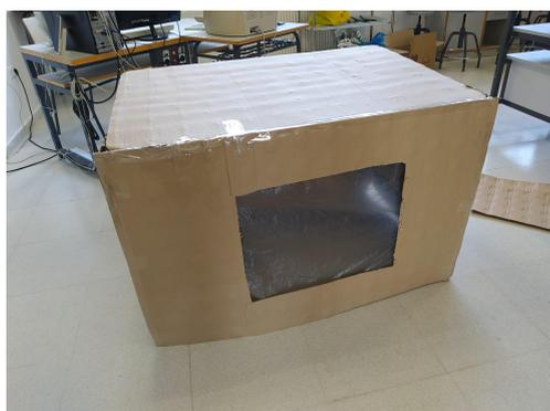
Figura 1. Caja utilizada para las mediciones de CO<sub>2</sub>.
