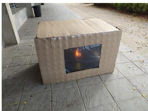
Figura 3. Medición del CO<sub>2</sub> emitido por el polipropileno.
