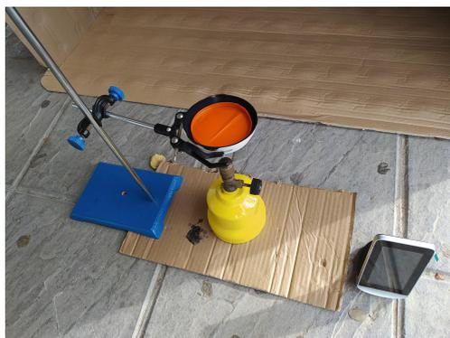
Figura 2. PP listo para quemarse en el centro. Medidor de CO<sub>2</sub> a la derecha.
