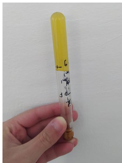
Figura 7. Fracción líquida gelificada.
